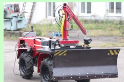
Робот на базе трактора BELARUS-132.
